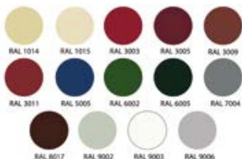
При выборе цвета рекомендуется учитывать его влияние на отражательную способность поверхностей. Чем светлее цвет поверхности, тем выше отражательная способность. Чем темнее поверхность, тем сильнее она нагревается, что приводит к тепловым деформациям, которые выражаются во вздутии облицовок между креплениями, а также в образовании складок в местах крепления сэндвич-панелей саморезами.
