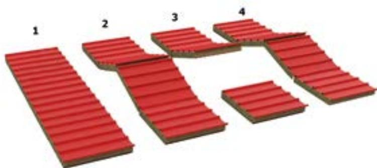
**Рис. 7. Порядок замены кровельных сэндвич панелей**
