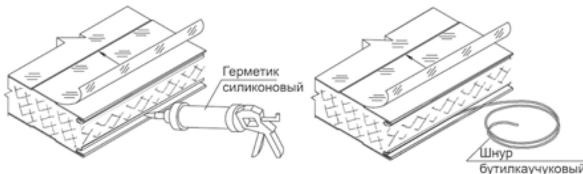
Уплотнитель имеет оптимальные размеры и клеевой слой, легко устанавливается в замок, перекрывая щели, но, не препятствуя соединению панелей в замке, имеет увеличенную длину. Все это значительно облегчает монтаж и дает лучшую герметичность стыка.
