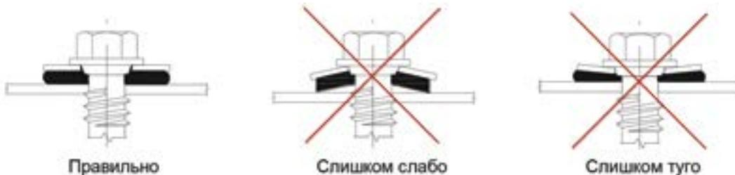
При монтаже сэндвич-панелей на стальных или деревянных конструкциях необходимо производить предварительную сверловку панелей под крепеж и использовать самонарезающие шурупы.
